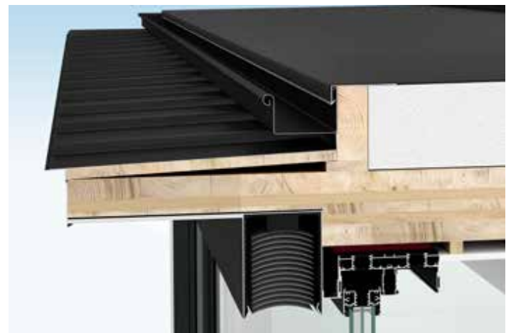
Designvariante „Gerade Kante“, abgesetzt aufgrund der Außenbeschattung
